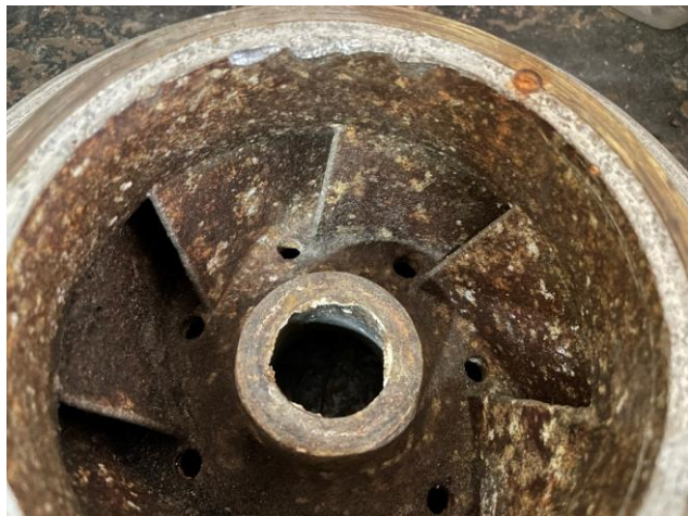
Рис. 1. Рабочее колесо насоса со следами различных дефектов
